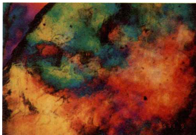
Abb. 16. Polarisationsmikroskopische Aufnahme der spontanen Orientierung eines teilfluorierten Blockcopolymers (onduliert hexagonale Mesophase).
