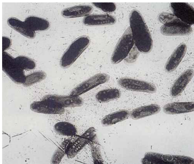
Abb. 14. Transmissionselektronenmikroskopische Aufnahme von unter Einfluß von Polysaccharidtemplaten gefällten Eisenoxiden.
