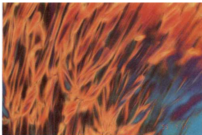
Abb. 10. Polarisationsmikroskopische Aufnahme der spontanen Orientierung einer polymerisierbaren, hexagonalen Mikroemulsionsphase.
